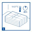
Instale o seu piso a uma temperatura entre 15 e 27°C.
