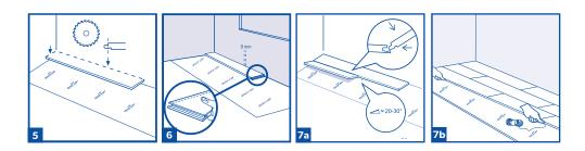
Com o piso vinílico Quick-Step você pode escolher onde deseja começar a instalação no ambiente. Pense em qual será a maneira mais fácil de instalar o piso. Vamos demonstrar a instalação do piso Quick-Step da esquerda para a direita. Devido ao sistema de click Uniclic, você pode trabalhar em qualquer direção.
